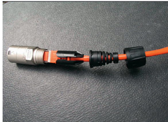
Abb. 11 So wird das Ethernet-Kabel in den Stecker eingeführt. Die Teile werden zusammengeschieben und mit der Überwurfmutter am Ende in das Metallteil gepresst.
