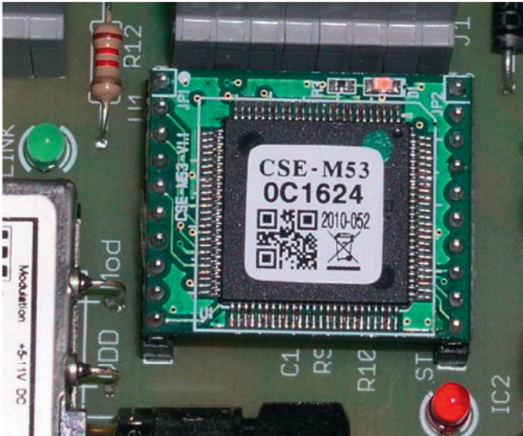
Abb.8 Ethernet-Interfacebaustein CSE-M53 im Sender.
