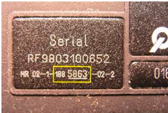
ID-Nummer auf dem Etikett auf der Geräterückseite. Die siebenstellige hier gelb eingerahmte Nummer ist die RIC.
